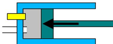
3. le carburant est injecté dans le gaz "brûlant"; une fois l'injection terminée, le cylindre poursuit sa détente
